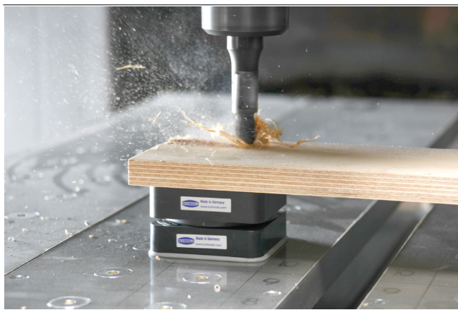
Innospann Cup y Base fijando una pieza de madera
